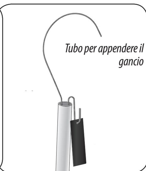
2. L'esempio sopra utilizza un tubo in PVC (ø20 mm) per poter appendere il gancio in punti elevati senza dover utilizzare scale. (Foto a destra)
